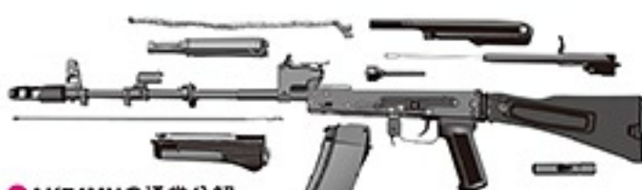
●AK74MNの通常分解 マズルブレーキが2穴式の試作だが、他はほぼ最終形態と思われる。ストック 側面の長方形の凹みは畳んだ時にマウントベースが干渉しない様に設けられている。
