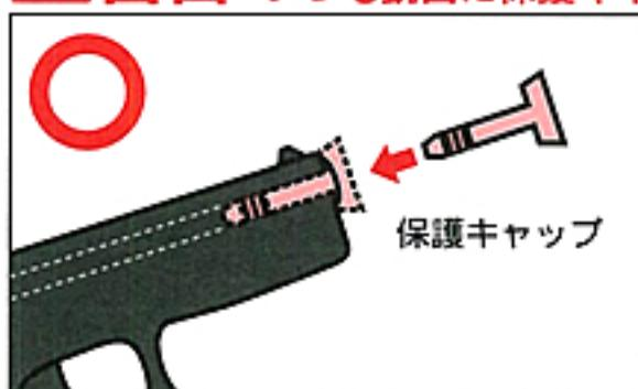
万一の暴発を防ぐと共に、防塵のために発射時以外は必ず銃口に保護キャップを装着して下さい(装着したまま引金を引かないで下さい)。
