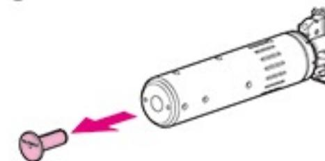
⚠ 万一の暴発を防ぐと共に防塵のため、発射を行う時以外は必ず銃口に保護キャップを装着してください。(装着したまま発射しないでください。)
