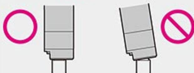
警告 逆ネジ部の形状から、取り付けの際に曲がってネジ込みやすいので注意してください。また、必要以上の力でネジ込むと、ネジ部分を破損しますので注意してください。フルオート・トレーサー、プロサイレンサーが軸線よりずれて装着されていると、発射したBB弾により破損する恐れがあります。
