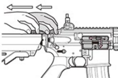
③ ボルトキャッチを押してオートストップを解除します。
