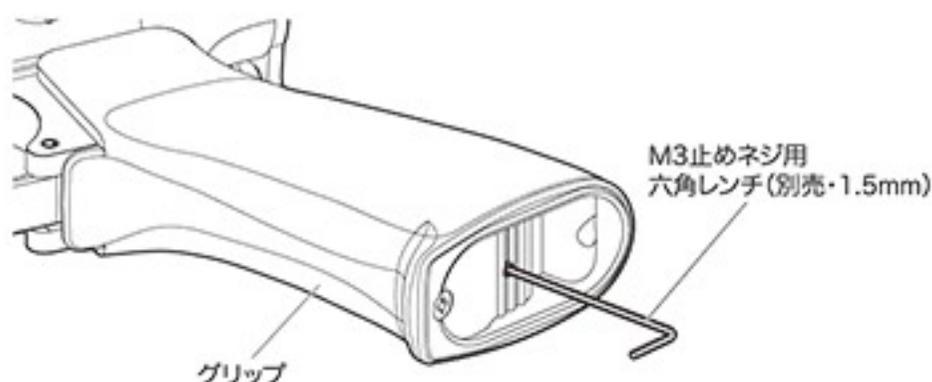
⚠ ネジの締めすぎ、緩めすぎはモーター破損の原因になります。
