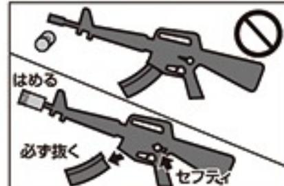
①銃口に保護キャップを装着する。②セレクトーレバーをセフティ位置にする。③本体からマガジンを抜く。④バッテリーを本体から取外す。
