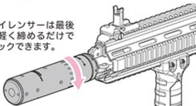
※過大な力で締め付けてしまうと、サイレンサー本体が外れなくなったり、サイレンサー後端パーツが残ってしまう恐れがあります。
