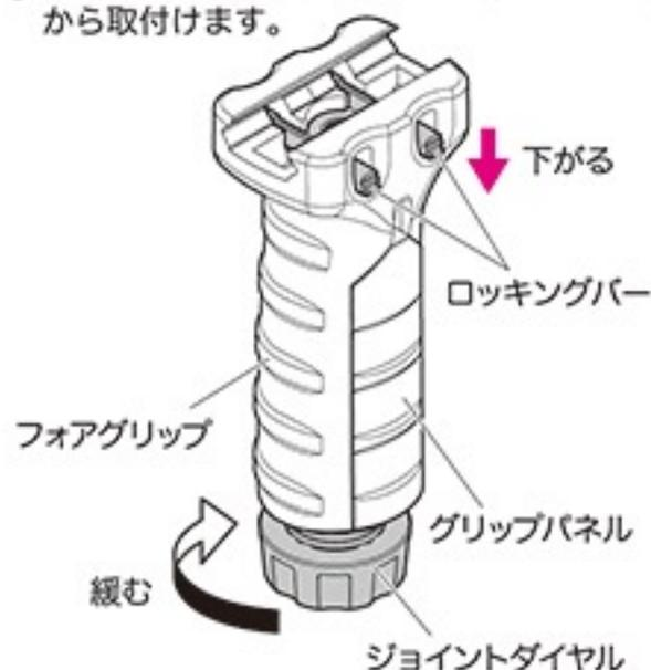
ジョイントダイヤルが回しにくい場合は、ダイヤル底部のミゾにコインを差し込むと回しやすくなります。
