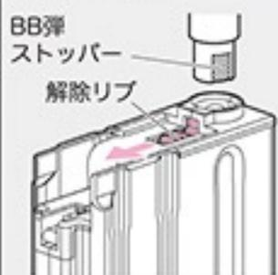
矢印の方向にリブをスライドさせると、マガジン内に残ったBB弾を取り出せます。(飛び出すので注意してください。)
