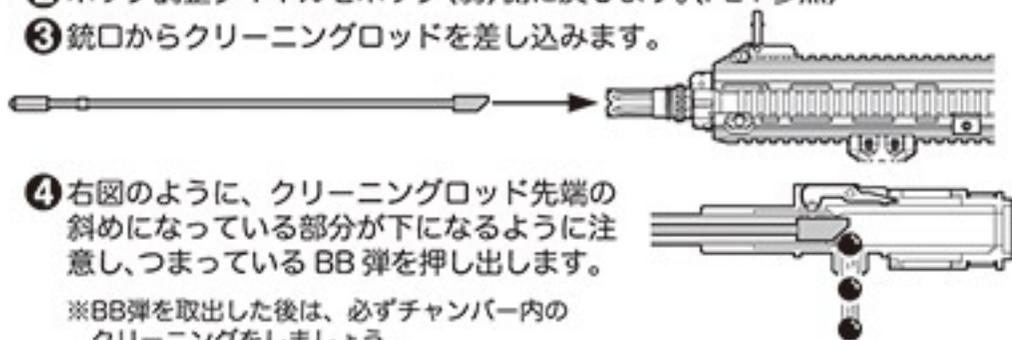
⚠ クリーニングロッドを無理に押し込まないでください。BB弾が押し出されない場合は、銃口に保護キャップを装着し、安全な方向に向けてセミオートで1度空撃ちしてから、再度クリーニングロッドで押し出します。
