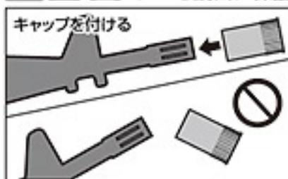
万一の暴発を防ぐと共に、防護のためにも、発射する時以外は必ず銃口に保護キャップを装着してください。
